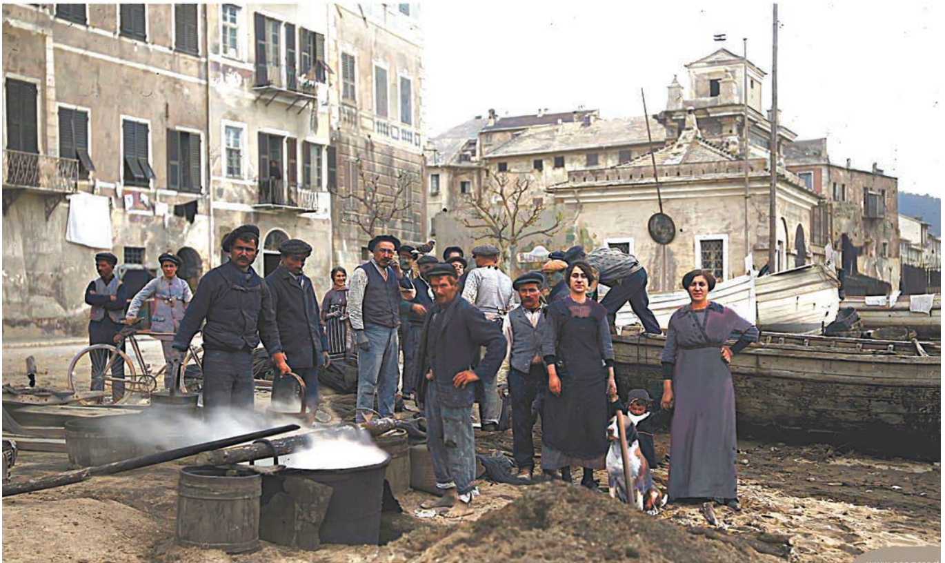
Via Concezione. I pescatori, aiutati dalle donne sono sempre al lavoro. Qui sono intenti alla bollitura della rusca per la tintura delle reti, per la quale si usava la corteccia del pino d'Aleppo macinata.
